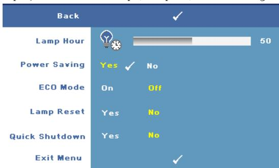
**LAMP HOUR (DURAÇÃO DA LÂMPADA)**—Mostre o tempo de funcionamento desde a última redefinição do temporizador da lâmpada.
